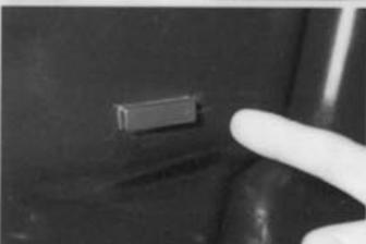
ボンネットを開けると反応するスイッチは、マグネットタイプを採用している。通常は上のタイプだが、これを取り付ける場合でもブラックに塗装して目立たなくするといった工夫が。
