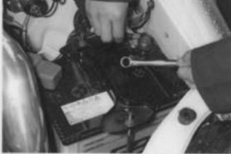
ボンネットを開けてバッテリーの端子を外す、というオーソドックスな手法だが、これでセキュリティシステムもOFF状態になってしまう。そのためバックアップバッテリーが有効なのだ。
