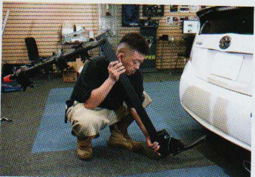
頑丈に作られたヒッチメンバーのクルマへのマウントは、アンダーフロア後部に4本のボルトでしっかりと固定すればOKという手軽さだ。
