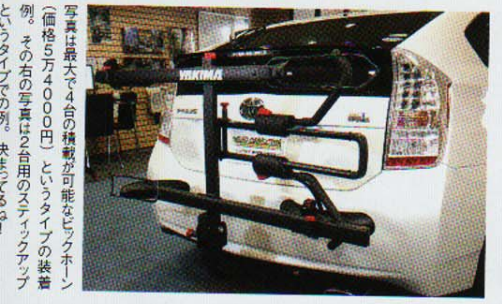
頑丈に作られたヒッチメンバーのクルマへのマウントは、アンダーフロア後部に4本のボルトでしっかりと固定すればOKという手軽さだ。
