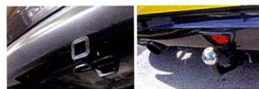
大きく分けて通常のトレーラーマウントとボールマウントの2種類があり、用途と車種によって使い分ける。
