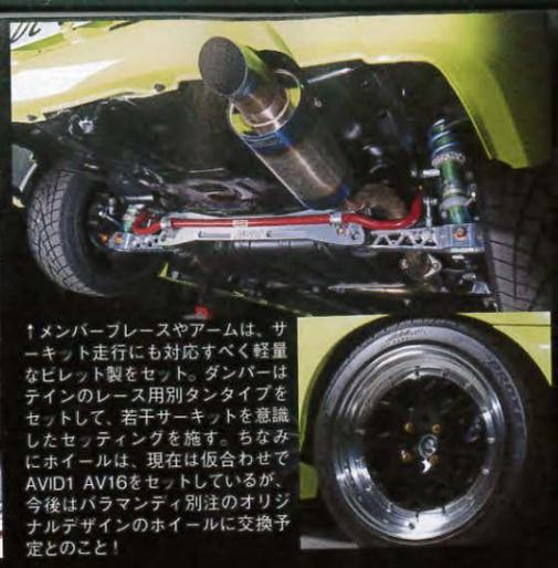
↑メンバーレースやアームは、サーキット走行にも対応すべく軽量のピレット製をセット。ダンパーはテインのレース用別タイプをセットして、若干サーキットを意識したセッティングを施す。ちなみにホイールは、現在は仮合わせでAVID1 AV16をセットしているが、今後はパラマンディ別注のオリジナルデザインのホイールに交換予定とのこと!
