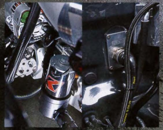
←日本流のエンジンスワップとは違い、ディテールリングまでこだわり抜いている。エンジンをスッキリとさせながら、フリクションを低減させる電動ウォーターポンプ化をはじめ、ワイヤータックも専用のRyWire製のコンバージョンハーネスを使用。ワンオフも考えたというパワステポンプブラケットは、奇跡的に新製品が出たKモーター製をチョイス。
